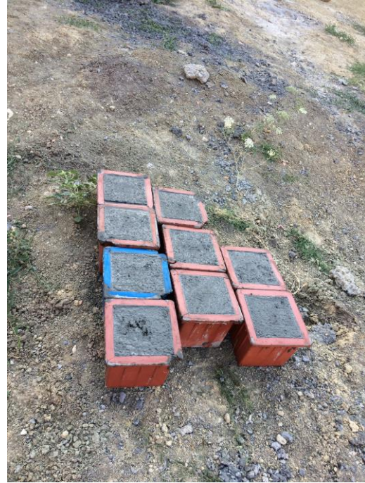
Şekil 2 Laboratuvara göndermek amacıyla alınan beton numuneleri
